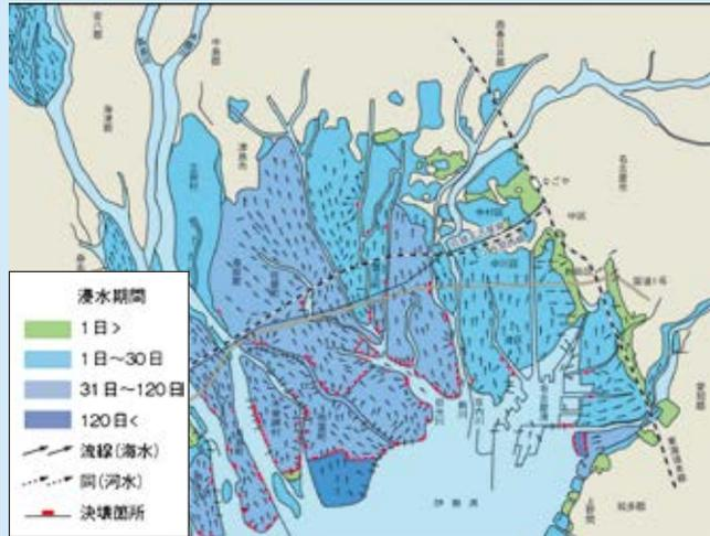
図2 堤防決壊箇所と浸水状況
