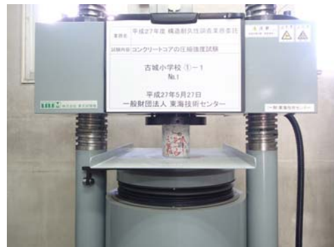
④圧縮強度試験
